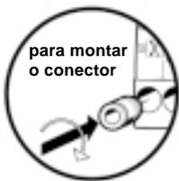
conexão roscada para o field bus
