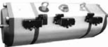
O atuador Parker de três posições fornece uma operação de 0°, 45° e 90° ou 0°, 90° e 180°. A posição intermediária é conseguida por um batente mecânico do movimento nos 2 pistões auxiliares.
