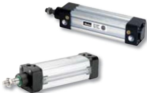
Os cilindros ISO possuem tubo em alumínio perfilado e anodizado, com canais para montagem dos sensores, protegendo tanto o sensor quanto o cabo elétrico e cabeçotes sem cavidades, o que evita o acúmulo de impurezas suspensas na atmosfera.
