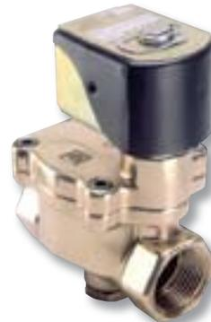
A válvula Série 24 é aplicável em qualquer tipo de automatização industrial para controle de fluidos e gases não-corrosivos e corrosivos, visto que a concepção de engenharia é simples e de longa durabilidade. Apresenta-se nas bitolas de 3/4" a 3" de diâmetro. Seu sistema tipo pistão tem um melhor desempenho em alta pressão e fluidos não-compressíveis.
