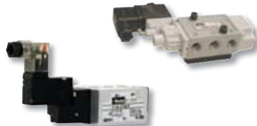
As válvulas Namur são indicadas normalmente para aplicação em atuadores pneumáticos utilizados na indústria de processos. A Série PVN possibilita obter a configuração 3/2 vias NF ou 5/2 vias, na versão simples solenóide, utilizando o mesmo corpo de válvula, simplesmente alterando a posição da placa de interface.
