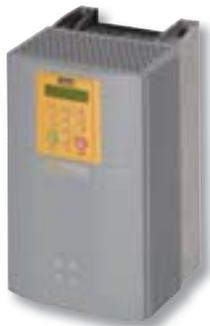
Os inversores de frequência da Série 690+ estão disponíveis em potência de 0,25 a 1500 CV, com entradas analógicas de alta resolução, funções avançadas: PID, cálculo de diâmetro, eixo eletrônico, funções matemáticas, temporizadores e funcionalidade de PLC.
