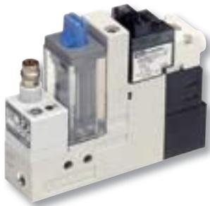
Compacto e leve, ótimo para processos de automação de alta velocidade. A Série MC2 integra uma válvula solenóide para gerar o vácuo e outra para liberação rápida da carga. Dispõe de uma válvula que possibilita controlar a expulsão da carga e conta, ainda, com filtro e silenciador.
