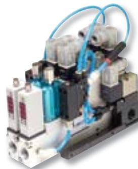
A Série CVX E-Stop é utilizada em aplicações que envolvem cargas frágeis sem porosidade. Tem como característica importante a operação E-Stop, sistema de emergência que, em caso de falha ou parada de energia, mantém o nível de vácuo evitando a queda da carga.
